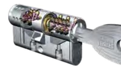
Il **cilindro di sicurezza** con protezione brevettata antiperforazione e antimani-polazione nelle tre dimensioni e con protezione antiestrazione e antistrappo. La forma grande e particolare della chiave rende agevole la chiusura e impedisce di piegare e spezzare la chiave stessa. Può essere bloccato da entrambi i lati. La chiave simmetrica reversibile può essere inserita nel cilindro molto facilmente.
