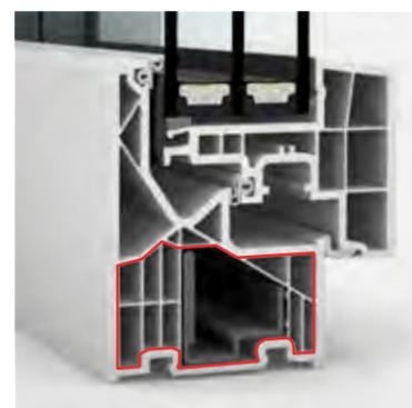
**Il profilo del telaio a 6 camere fornisce un migliore isolamento termico.** Tre guarnizioni perimetrali proteggono l'interno della finestra dall'umidità e migliorano anche l'isolamento termico e acustico. Attraverso l'incollaggio perimetrale della lastra di vetro alla finestra, I-tec Glazing garantisce un'eccellente stabilità e protezione dalle effrazioni.
